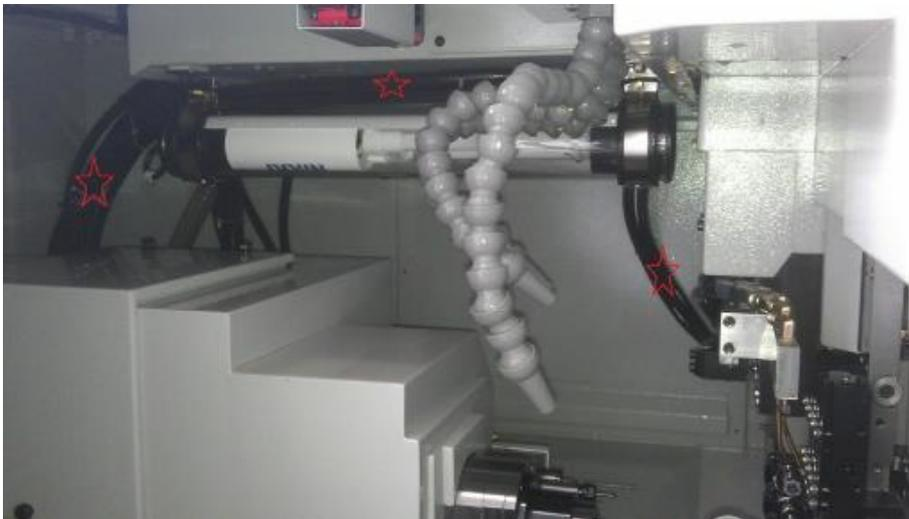
注：有红色★标记的为油管。油管固定后，刀架自动移动时，请注意不要与任何地方发生干涉。
